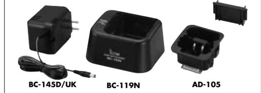
Schnelllader für den im Funkgerät befindlichen NiCd-Akkupack BP-202. Netzadapter und Ladeadapter werden mit dem BC-119N geliefert. Ladezeit 75 bis 85 min.
